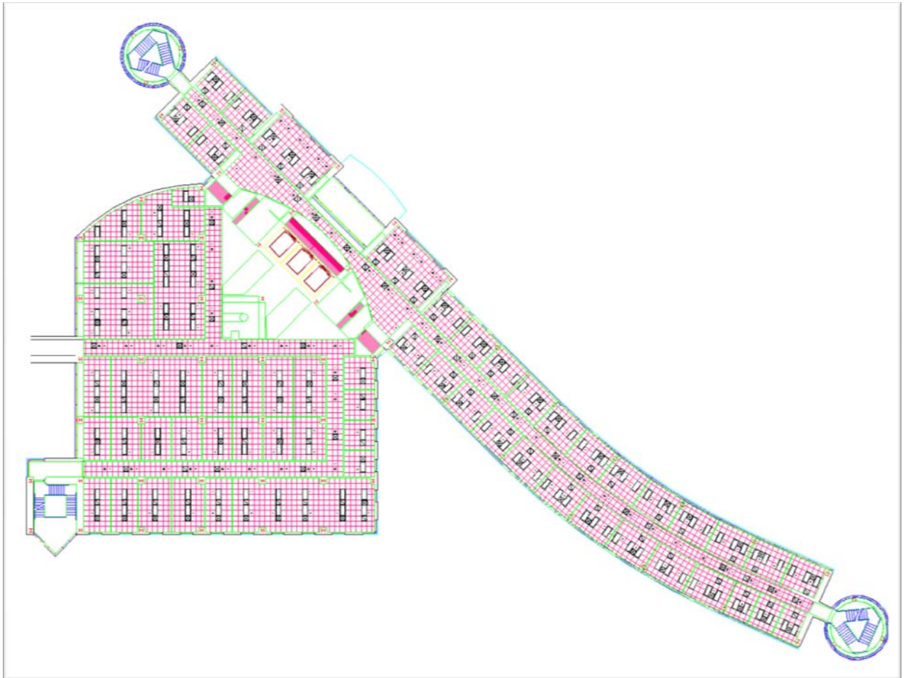
Kuva 4: Tehtävän 4 valmis piirustus – toimistorakennuksen alakattopiirustus.
